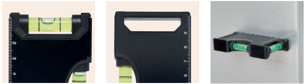
56-0380007 CARNELIAN Spirit level VE: 20/100 St. | Größe: 10,8x5,5x2 cm | Material: Aluminium / Acryl / Kunststoff | Veredelung: 5 cm² LY5+H2 (1) Wasserwaage: aus Aluminium, 2 separate Libellen für horizontale und vertikale Ausrichtung, aufgedruckte Skalierung bis 10 cm, integrierter Magnet für einfache Befestigung an metallischen Oberflächen, mit Kunststoffgriff zum Aufhängen, in Box
