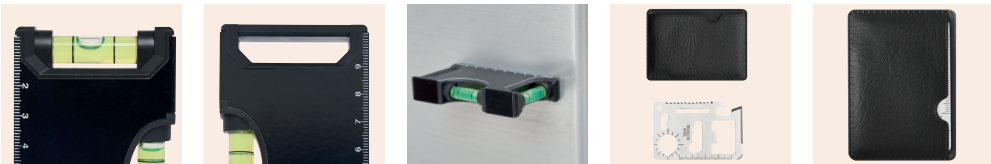
56-0380007 CARNELIAN Spirit level Imballo: 20/100 pz. | Dimensione: 10,8x5,5x2 cm | Materiale: alluminio / acrilico / plastica | Dimensione di stampa: 5 cm 2 LY5+H2 (1) Livella: in alluminio, 2 bolle separate per allineamento orizzontale e verticale, scala fino a 10 cm, magnete integrato per un facile fissaggio su superfici metalliche, con manico in plastica per appenderla, confezione in scatola
